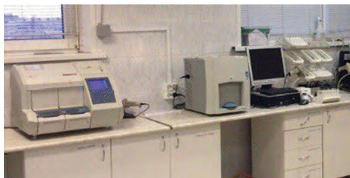
Рис. 7. Экспресс-анализатор bioMerieux TEMPO TC (Франция) (слева), экспресс-анализатор bioMerieux miniVidas (Франция) (справа).
