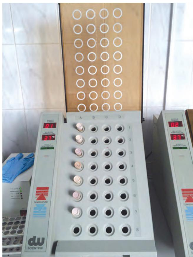
Рис. 11. Экспресс-анализатор Don Whitley Scientific RABIT (Rapid Automated Bacterial Impedance Technique) (Великобритания).
